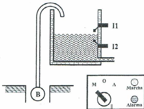
Un microrruptor (boya de nivel) I1 que detecta el nivel máximo del agua, y otro microrruptor I2 que detecta el nivel mínimo.
